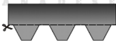
Picture Nr. 2 Trimming the tabs
